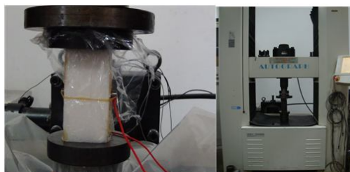
图 1 加载试验机和探头布置
