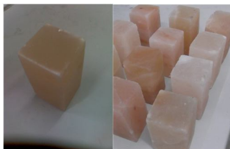
图 2 加工完成的盐岩试件样品
